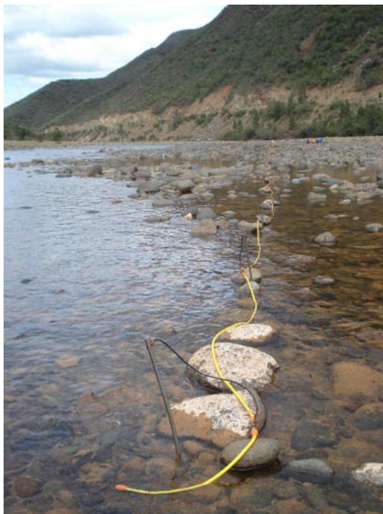
L'équipement de tomographie électrique est composé d'un terramètre, d'un sélecteur d'électrodes, de câbles multi-canaux, d'électrodes en inox et de connecteurs (pinces reliant l'électrode au câble). Le dispositif de mesures est en général constitué de quatre câbles de seize sorties chacun, espacés de 5 ou 10 m. Chaque sortie est reliée à une électrode, plantée dans le sol. La profondeur d'investigation d'un tel dispositif peut atteindre 100 m (espacement d'électrodes de 10 m, dispositif Gradient-Wenner).
